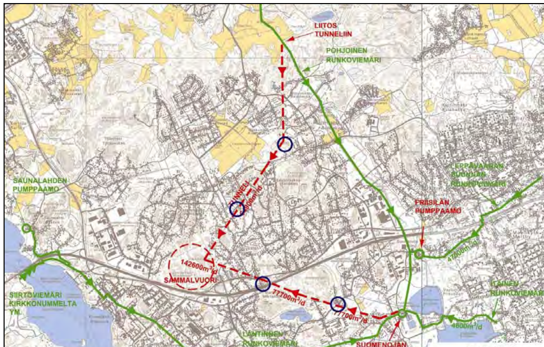
Kuva 4.11. Alustavat tulotunnelien linjaukset Sammalvuoreen (vihreä viiva = nykyiset viemäriinjat; punainen katkoviiva = uusi tulotunneli, sininen ympyrä = työtunnelin suuaukko).
