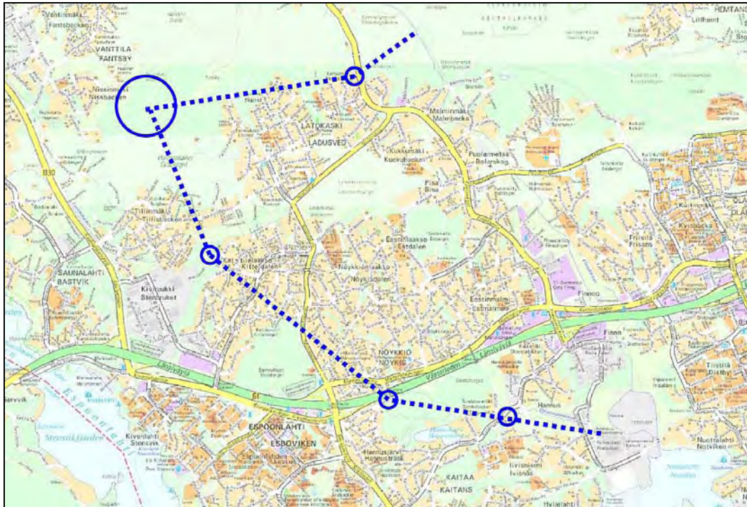
Kuva 4.14. Alustavat tulotunnelien linjaukset Harmaakallioon.
